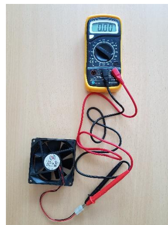
Slika 5: Meritev napetosti z multimetrom
