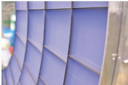
Čerenkovo sevanje nastane pri prehodu nabitih delcev, s hitrostjo večjo od svetlobne hitrosti v snovi, skozi plošče silicijevega aerogela.
