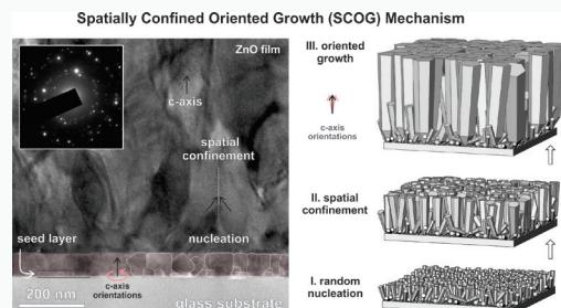
TEM posnetek nukleacijske plasti in začetne stopnje rasti plasti ZnO s shematskim prikazom mehanizma rasti pod prostorsko omejenimi pogoji. SCOG mehanizem ima tri stopnje: (i) naključna orientacija, (ii) prostorska omejitev in (iii) orientirana rast.
