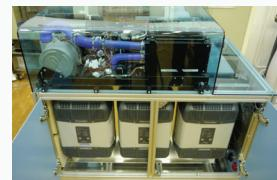
8 kW električni agregat na PEM gorivne celice.
