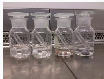
Prikazani so različni nosilci, na katere smo dodali bakterije s pomočjo elektrostatskih interakcij. Meritve temeljijo na loviljenju nastalega CO<sub>2</sub> v pasteh (eprvete v posodicah) ter scintilacijski meritvi ujetega karbonata.
