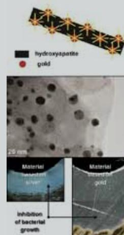
**Shema strukture novega materiala na osnovi zlata, mikroskopski posnetek sintetiziranih nanodelcev ter prikaz primerjave antibakterijskih lastnosti novega materiala z zlatom in materiala s srebrom.**
