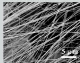
Vrstični elektronsko mikroskopski (SEM) posnetek kristalov W<sub>5</sub>O<sub>14</sub>. (Vir: M. Remškar, Odsek za fiziko trdne snovi)
