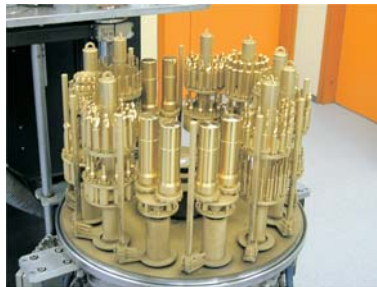
Orodja, zaščitena s TiN prevleko (Avtor posnetka: P. Panjan)
