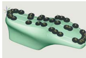
CAD-sistem za določanje trajektorij lepljenja (Foto: Odsek za avtomatiko, biokibernetiko in robotiko)
