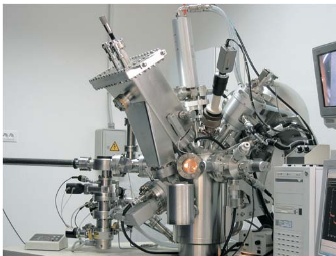
Spektrometer fotoelektronov, vzbujenih z rentgenskimi žarki (XPS) za analizo sestave in kemijskega stanja elementov na površinah in v tankih plasteh. (Avtor posnetka: J. Kovač)
