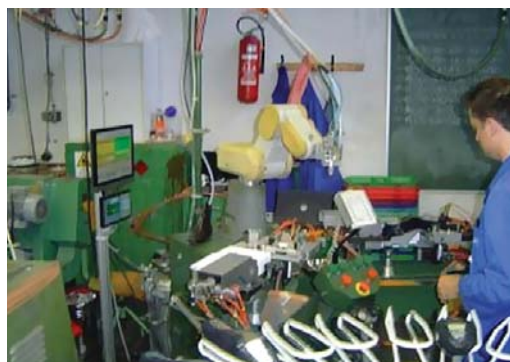
Avtomatizacija lepljenja podplatov v tovarni ALPINA. (Foto: Odsek za avtomatiko biokibernetiko in robotiko)
