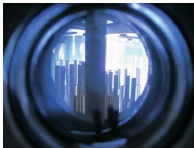
Čiščenje površine orodij z argonovimi ioni iz plazme tik pred nanosom trde prevleke (Avtor posnetka: P. Panjan)
