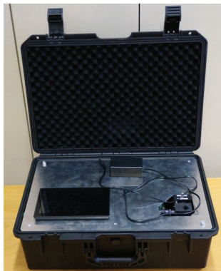
Prenosna naprava za merjenje življenjskega časa fluorescence (avtor dr. Rok Dolenec)
